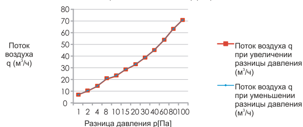
График 7. Зависимость потока воздуха q (м 3 /ч), протекающего через клапан VT 701, от разницы давления p (Па)
