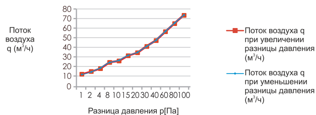
График 1. Зависимость потока воздуха q (м 3 /ч), протекающего через клапан VT 101, от разницы давления p (Па)
